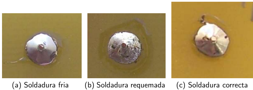
Figura 13: Diferentes defectos en una soldadura.
