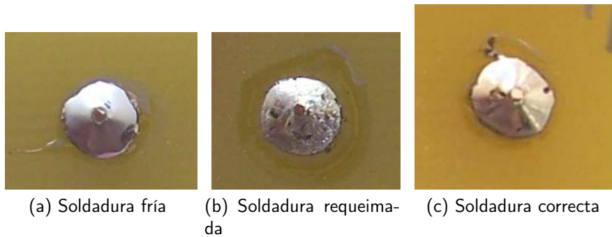
Figura 13: Diferentes defectos nunha soldadura.
