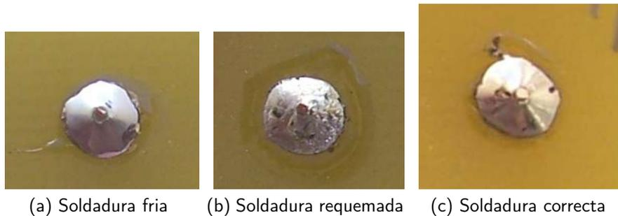
Figura 13: Diferentes defectos en una soldadura.
